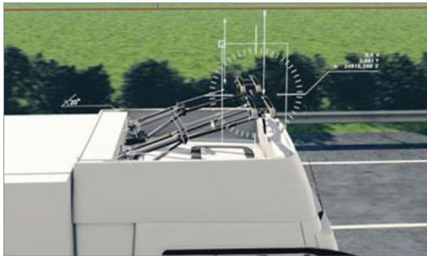
eHighway 시스템은 전기 구동이 더 높은 효율을 가지기 때문에 디젤을 사용하는 트럭보다 약 2배 정도 더 효율적이다. 게다가 상부 전력선은 99%의 효율로 전기를 전송한다. eHighway 시스템은 트럭이 남는 전기 제동 에너지를 전력 계통으로 다시 보낼 수 있기 때문에 전기이용 효율성도 매우 높다고 볼 수 있다.
