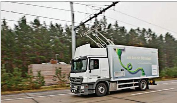
일반적인 전기 교통시스템과 유사하게, eHighway 시스템은 4개의 서브 시스템으로 구성된다. 전기 트럭, 전원 공급 및 배포 장치, 주행로, 그리고 운영제어센터이다.
